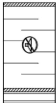
本段可采用微孔板消声器，微孔板消声器内部为空腔，利用共振吸声原理，具有不污染，不受潮的有点，其多低频及中频噪声具有有效的消声作用，适用场所：净化型等不允许使用消音棉的场所。
